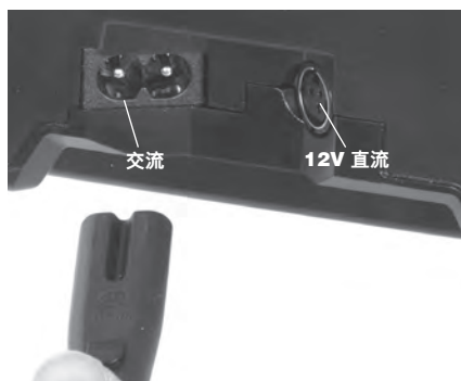
图 9 - 充电器电源线连接
