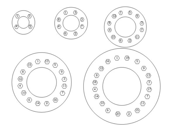
FIGURE 4. FLANGE BOLT TIGHTENING SEQUENCE
